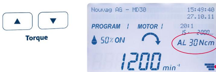
Der Aufbau des Drehmoments wird hier graphisch dargestellt. Beim Erreichen des eingestellten Drehmoments sind alle Elemente des Balkens sichtbar.
