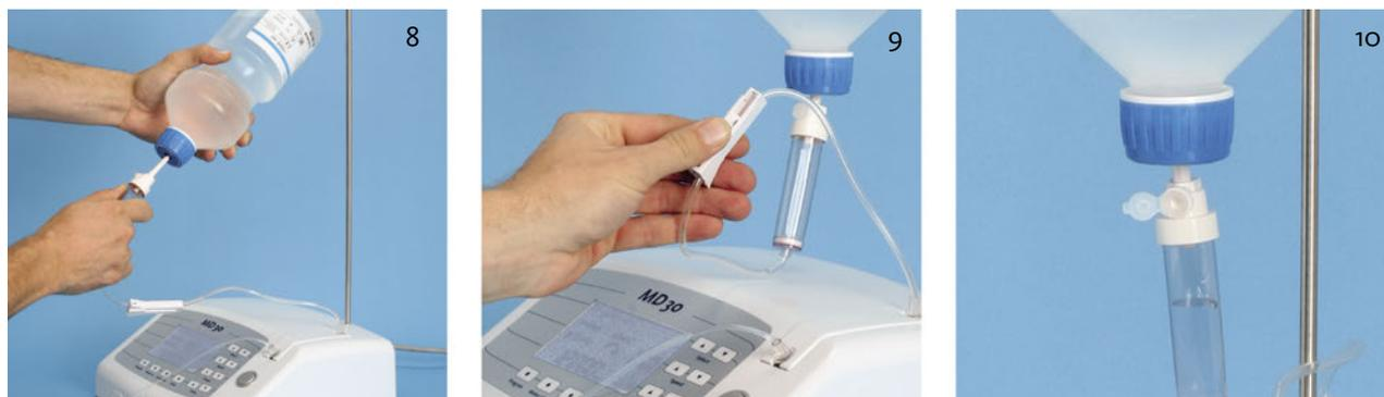
8. Einstechdorn des Schlauchsets in die Gummimembran des Verschlusses der Kühlmittelflasche einstecken und Flasche am Stativ aufhängen.
