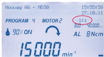
«**Handpiece**»-Taste mehrmals drücken bis der Name des gewünschten Hand- oder Winkelstücks oder des entsprechenden Über-, bzw. Untersetzungsverhältnis auf dem Display angezeigt wird. Wird die Taste anhaltend gedrückt, erscheinen die Hand- und Winkelstücke aufeinanderfolgend.
