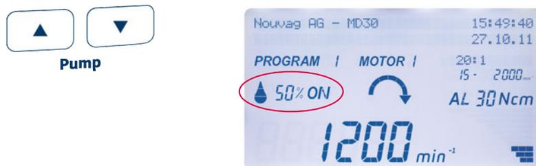
Minimum und Maximum der Pumpen-Fördermenge wie auch die Bedienschritte können im Konfigurationsmenü angepasst werden (siehe «7.8 Konfigurationsmenü, Parameter Level 2, Pump»).
