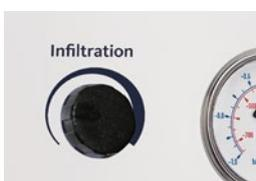
Mit dem Regler «Infiltration» wird die maximale per Pedal abrufbare Förderleistung der Infiltrationspumpe eingestellt. Durch Drücken der Trittplatte des VARIO-Pedals wird die Infiltration gestartet, variiert und gestoppt.
