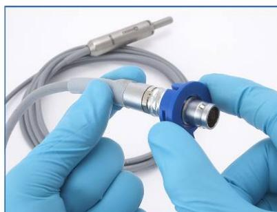
Blockier-Ring über den Stecker ziehen und am Kabel bis zum Motor führen.
