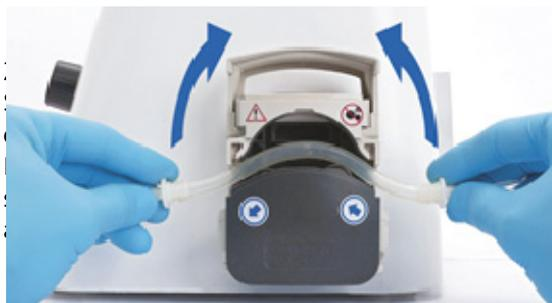
Zur Fixierung des Schlauchabschnittes die beiden Schlauchklemmen rechts und links der Infiltrationspumpe einstellen. Pumpe verriegeln und durch Drehen der Rändel-Räder die Schlauchklemmen sanft an den Schlauch heranfahren. Der Schlauchabschnitt bleibt in dieser Position fixiert.
