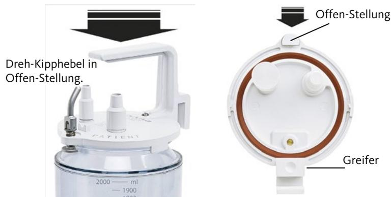
3. Dreh-Kipphebel am Sammelbehälter-Deckel um 180° drehen (Dreh-Kipphebel zeigt jetzt vom Handgriff des Deckels weg). Darauf achten dass der Riegel unter den Wulst der Sekret-Flasche greift.
