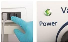
Mit dem Hauptschalter «I/O», auf der Rückseite des Gerätes, wird das Steuergerät ein- und ausgeschaltet. Auf der Frontseite des Gerätes wird die Bereitschaft mit einem grünen LED-Licht (Power) angezeigt. Das Ausschalten kann jederzeit erfolgen und ist nicht von einer Ausschaltprozedur abhängig.
