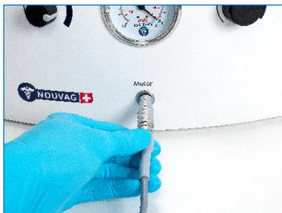
Motor-Stecker in Motor-Buchse am Steuergerät einstecken.
