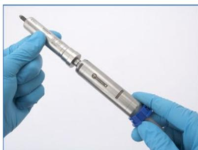
Getriebe-Kapsel auf Elektronikmotor montieren und drücken bis es klickt.
