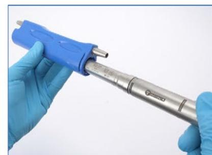
Getriebe-Motor-Einheit in Handgriff einführen ...
