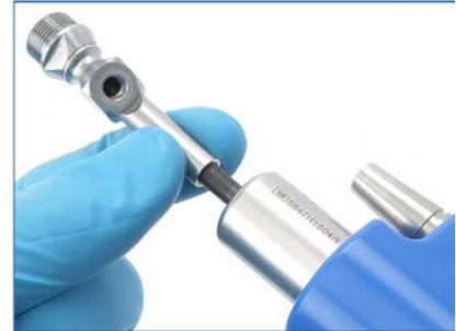
Kanülen-Adapter auf Getriebekapsel schrauben.
