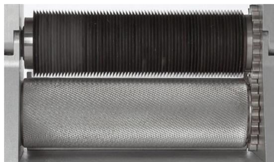
2. Markierung der Transport-Rätche auf das abgeflachte Stück der Achse der Klingenwalze ausrichten und aufsetzen.
