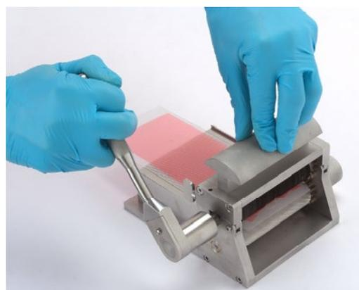
Es kommt vor, dass der Hautabschnitt durch die Klingenzwalze während des Einzugs von der Trägerplatte abgezogen wird. Deshalb ist es unerlässlich den Mesh-Vorgang auch auf der Rückseite des Meshers mit zu verfolgen und notfalls den Hautabschnitt manuell von der Klingenzwalze abzuziehen und wieder auf die Trägerplatte zu legen.
