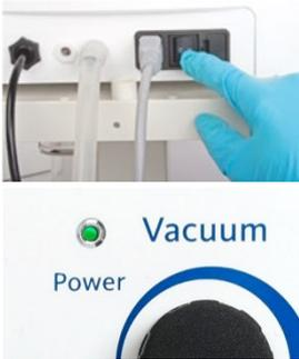
Mit dem Hauptschalter «I/O», auf der Rückseite des Gerätes, wird das Steuergerät ein- und ausgeschaltet. Auf der Frontseite des Gerätes wird die Bereitschaft mit einem grünen LED-Licht angezeigt. Das Ausschalten kann jederzeit erfolgen und ist nicht von einer Ausschaltprozedur abhängig.
