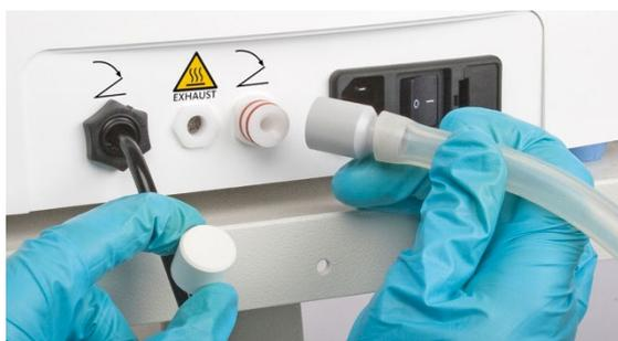
5. Kurzes Silikon-Schlauchstück (400 mm lang) am einen Ende mit der kleinen Verbindungshülse des Flaschendeckels (VACUUM) verbinden. Anderes Schlauchende mit dem Bakterienfilter verbinden.
