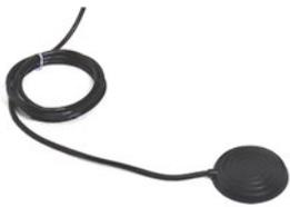
Das mit den Vacuson 40/60 mitgelieferte ON-OFF-Pneumatik-Pedal löst, wenn gedrückt, einen Schalter im Gerät aus, um die Pumpe ein- bzw. auszuschalten. Dies geschieht über ein Luftpolster. Nach dem Einschalten des Gerätes Pneumatik-Pedal drücken. Pumpe läuft und generiert Vakuum. Erneutes Drücken des Pedals schaltet die Pumpe aus. Die Pumpe kann nur mit dem Pedal aktiviert werden. Der letzte Zustand vor dem Ausschalten bleibt aktiv.
