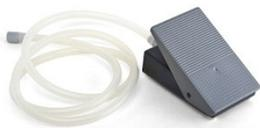
Wurde mit Ihrem Vacuson-Gerät zusätzlich ein VARIO-AIR-Pedal (REF 4242) geordert, kann damit das Vakuum reguliert werden. Das VARIO-AIR-Pedal öffnet beim drücken ein Ventil das die Zufuhr von Fremdluft steuert. Je weiter das Pedal gedrückt wird, desto mehr Fremdluft wird angesaugt, desto schwächer wird die Saugleistung an der Kanüle. Der Vacuum-Regler muss bei der Steuerung über das VARIO-AIR-Pedal in Maximal-Stellung sein. Das VARIO-AIR-Pedal wird zusammen mit dem Pneumatik-Pedal benutzt.
