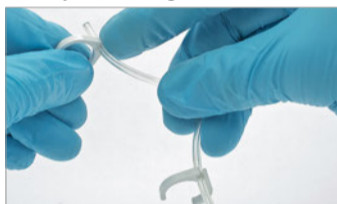
Asegurar los clips en el tubo de la refrigeración.
