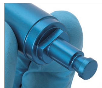
A peça equivalente do acoplamento Hudson existente na broca de perfuração tem de ser inserida alinhada com o entalhe existente na outra parte.
