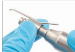
Desserrer le clip de refroidissement par un mouvement de va-et-vient.
