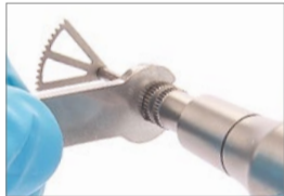
Desserrer l'écrou-raccord avec la clé à ergot.
