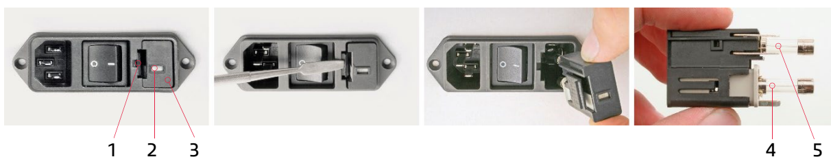
1 Zámek štěrbinu pro pojistky 2 Zobrazovací okénko pro nastavené napětí 3 Štěrbinu pro pojistky 4 Pojistka 1 5 Pojistka 2
