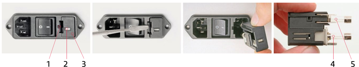
1 Zámek štěrbinu pro pojistky 2 Zobrazovací okénko pro nastavené napětí 3 Štěrbinu pro pojistky 4 Pojistka 1 5 Pojistka 2
