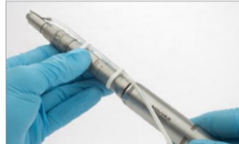
Fixer le moteur (optionnel) sur la bride d'accouplement.
