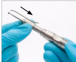
Fastgør køleklipsen til håndstykket.
