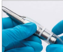
Fastgør slangefastgørelsesclipsen (REF 1881) til irrigationsslangen, og klips den fast på håndstykket.
