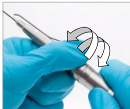
Hold håndstykket med én hånd i den nedre delen og åpne klemmen ved å dreie strammemuffen med den andre hånden i en motgående bevegelse til den klikker.
