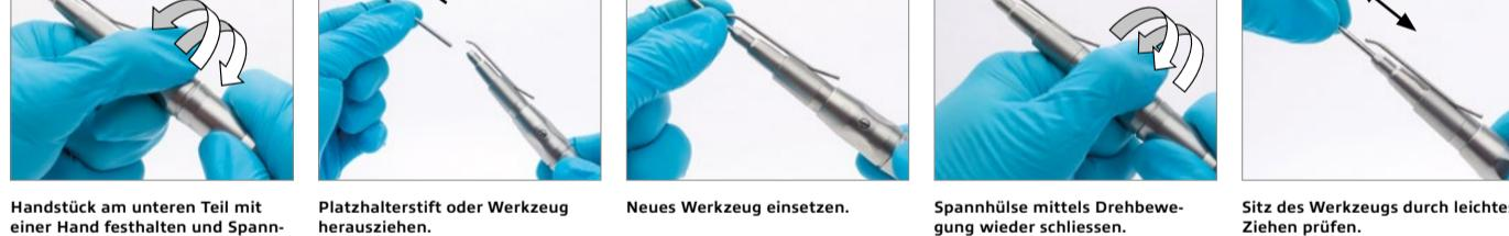
Handstück am unteren Teil mit einer Hand festhalten und Spannhülse mit der anderen Hand durch eine Gegendrehung öffnen bis zum Klick.
