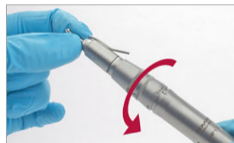
Schnellspannverschluss schliessen und durch leichtes Ziehen prüfen, ob das Werkzeug richtig fixiert ist.
