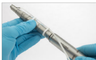
Motor (nicht im Lieferumfang) am Kupplungsflansch anschliessen.
