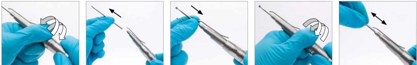
Segurar a peça de mão com uma mão na parte inferior e abrir o grampo rodando a manga de aperto com a outra mão em movimento contrário até ouvir um estalido.
