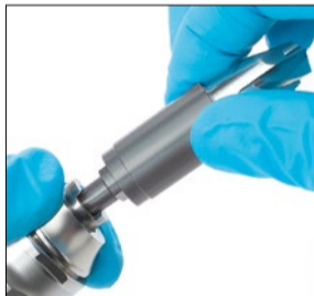
Insérez le foret de perforation avec la bague de fermeture ouverte.
