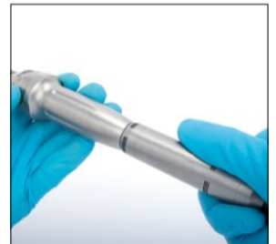
Inserir el motor electrónico en la parte trasera de la pieza de mano del Perforador craneal y presionar firmemente sobre el acoplamiento de la pieza de mano hasta que encaje en su lugar. Verificar la colocación.
