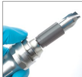
Soltar el anillo de cierre y comprobar la colocación de la taladro de perforación.
