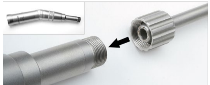
Inserire il gambo della fresa nel mandrino aperto del manipolo angolato fino all'arresto e chiudere il mandrino ruotando il manicotto di serraggio. Avvitare il dado di serraggio sul manipolo angolato per fissare il manicotto di supporto in posizione.
