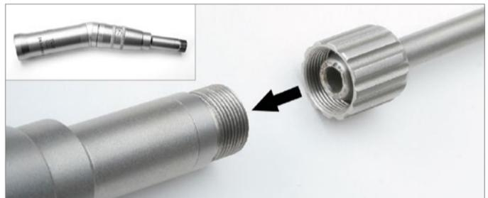
Insérer la tige de la fraise rotative dans la pince de serrage ouverte de la pièce à main coudee jusqu'à la butée et fermer la pince de serrage en tournant la douille de serrage. Visser l'écrou de serrage sur la pièce à main coudee pour fixer la douille de support en place.
