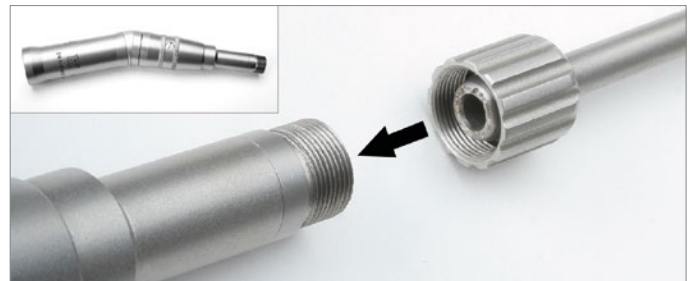
Fräferschaft in offene Spannzange des gewinkelten Handstücks bis zum Anschlag einführen und Spannzange durch Drehen der Spannhülse schliessen. Spannmutter an das gewinkelte Handstück anschrauben, um das Aussenrohr zu fixieren.
