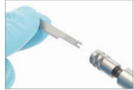
Sacar la hoja dentada de la mordaza y, si fuera necesario, sustituirla.
