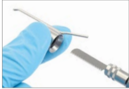
Quitar el clip de refrigeración de la pieza de mano con sierra.
