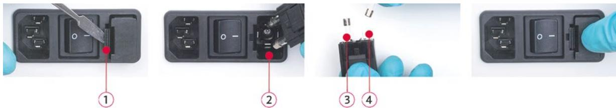
1 Mecanismo de bloqueio 2 Janela que indica a definição da tensão 3 Compartimento de fusíveis 4 Fusível 1 5 Fusível 2
