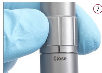
Spanner in „Close“-Position (geschlossen) drehen.
